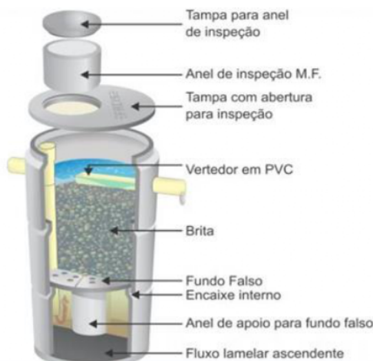
Figura 04 - Filtro anaeróbio de fluxo ascendente.
