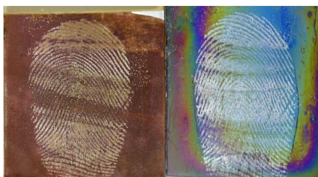
Figura 32- Impressão digital revelada através da eletrodeposição do PPy em LiClO 4 dopado com a) alaranjado de metila b) índigo carmim.
