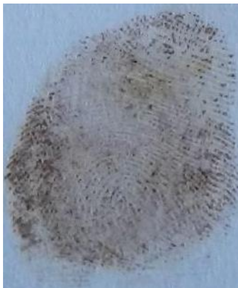
Figura 5- Revelação da impressão digital pela técnica de vapores de iodo.
