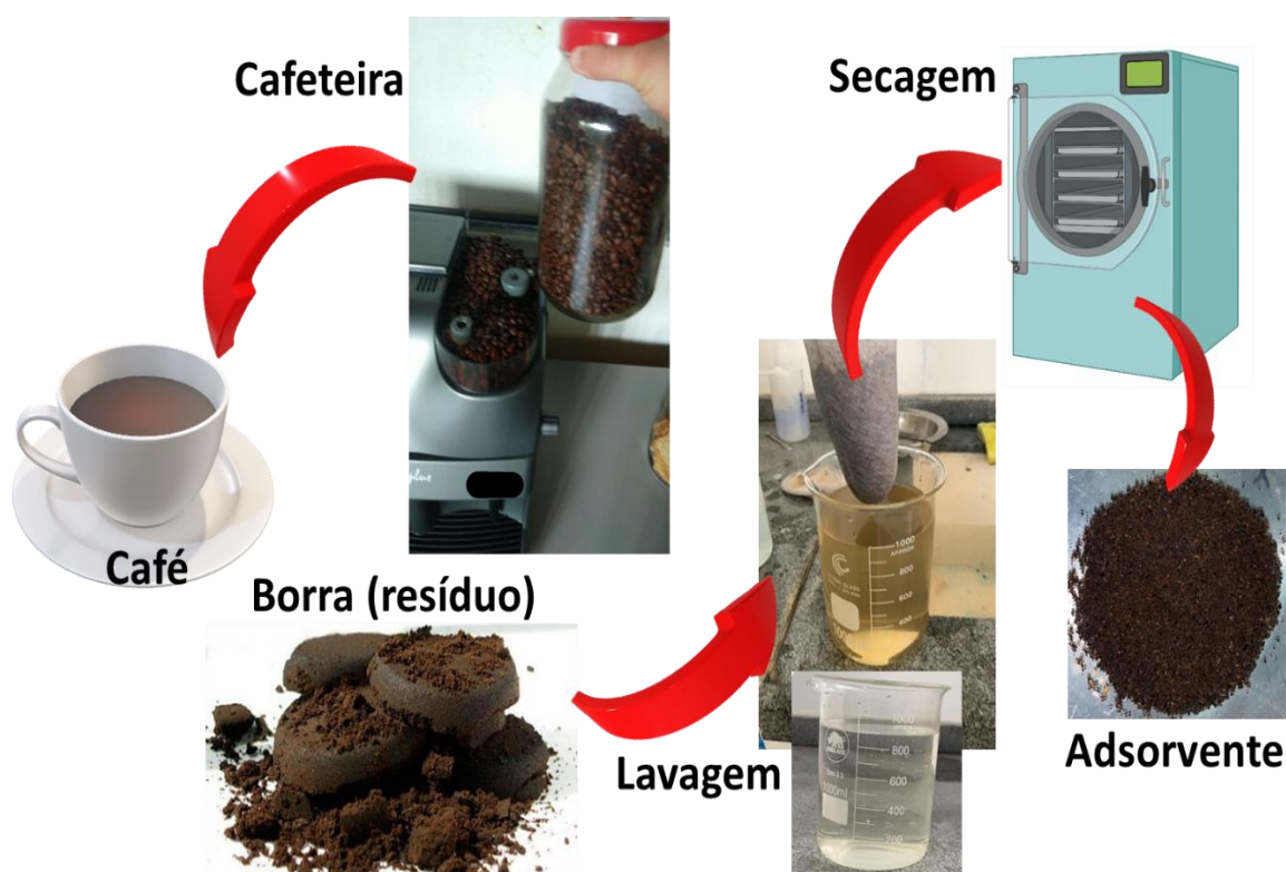
Figura 3 – Etapas da preparação do adsorvente.
