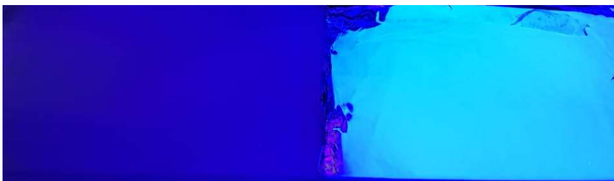
Figura 11 - Membranas de PCL, à esquerda, e de PCL / FBT, à direita, sob luz UV ( \lambda = 365 nm).
